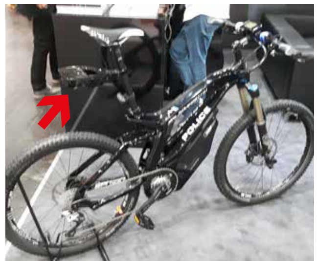
Der Scanner (siehe Pfeil) unter dem Sattel kann Kennzeichen und Gesichter von Menschen scannen und mit einem Fahndungsprogramm abgleichen
