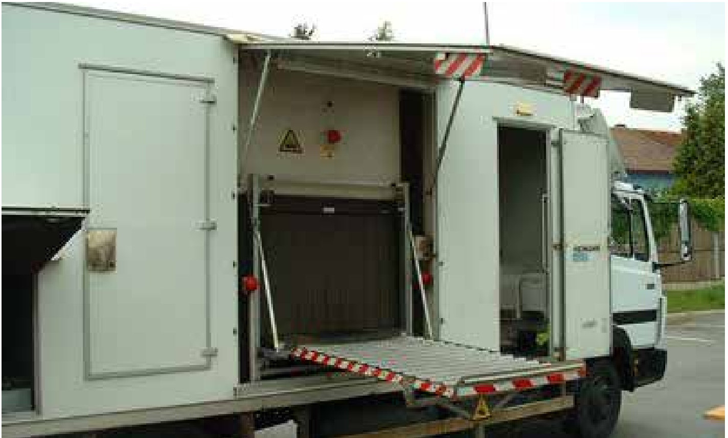
Das Scanmobil ist für das Einladen und Röntgenisieren verdächtiger Gegenstände aller Art hergerichtet
